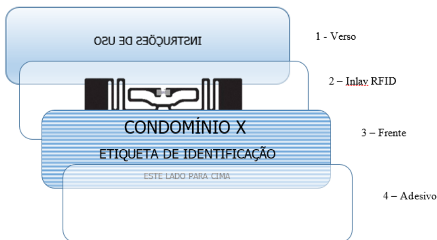
Figura 2 - Composição da etiqueta de identificação do veículo
