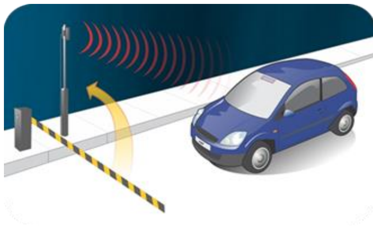
Figura 5 - Funcionamento do leitor RFID para veículos
